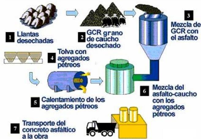
**Figura 14.** Proceso adición polvo NFU al asfalto por vía húmeda.
