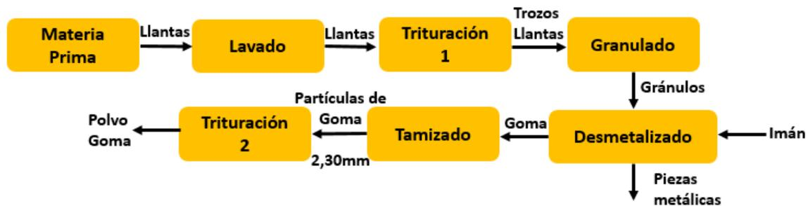
Figura 12. Proceso de trituración de neumáticos.
