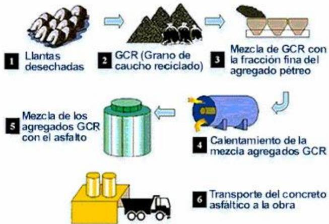
**Figura 13.** Proceso adición polvo NFU (Neumáticos fuera de uso) al asfalto por vía seca.
