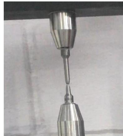
*Ilustración 7: Falla de la probeta. Fuente: autores.*
