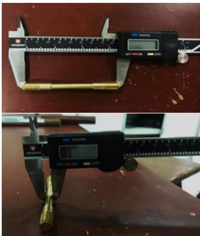
**Ilustración 9:** Toma de medidas con pie de rey. Fuente: autores.
