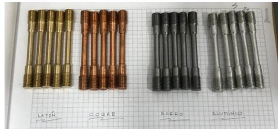
*Ilustración 32: Probetas de diferentes materiales. Fuente: autores.*
