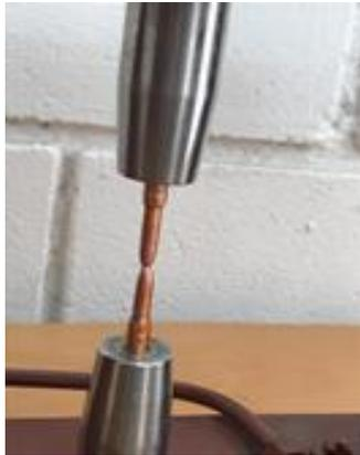
Ilustración 12: Falla de la muestra. Fuente: autores.
