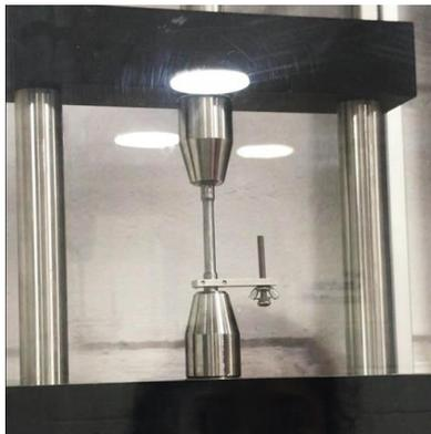
*Ilustración 5: Montaje de la probeta. Fuente: autores.*
