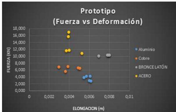
**Ilustración 14:** Fuerza vs Elongación de los materiales (aluminio, cobre, bronce latón y acero). Fuente: autores.
