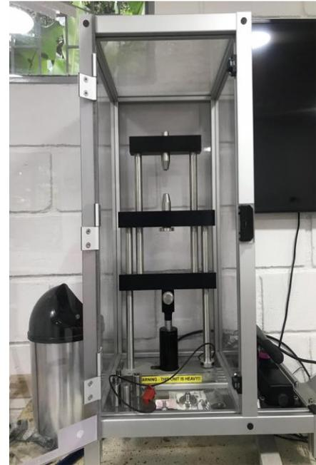
**Ilustración 2:** Máquina Calibrada para tracción o compresión. Fuente: Autores.
