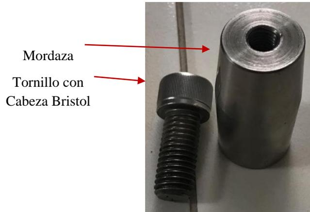
*Ilustración 24: Ajuste de placa con mordaza. Fuente: Autores.*
