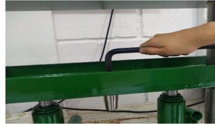
*Ilustración 37: Enroscamiento a través de llave y tornillo Bristol. Fuente: autores*
