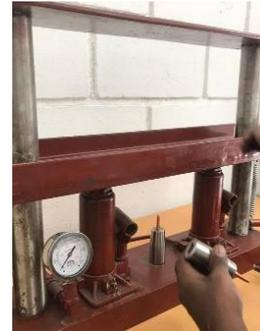
**Ilustración 42:** Retiro de la probeta fallada. Fuente: Autores.
