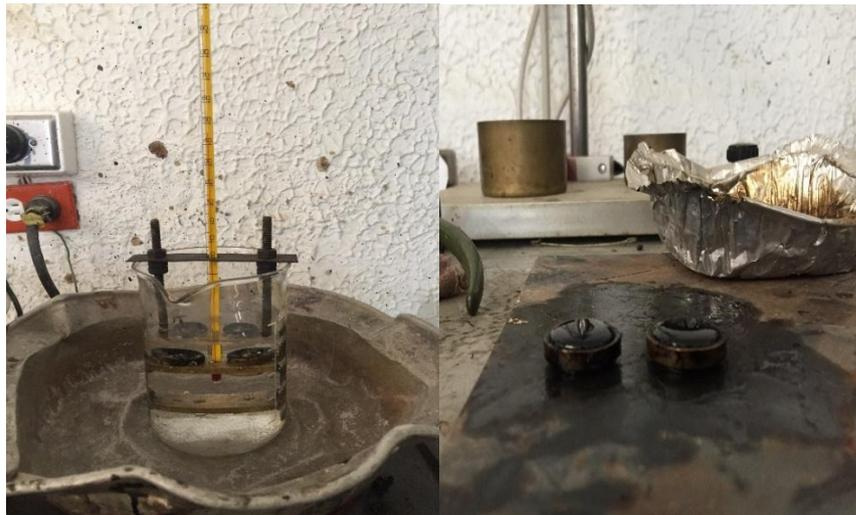
*Ilustración 5 Ensayo de punto de ablandamiento*
