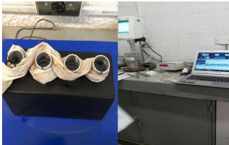
*Ilustración 10 Ensayo de viscosímetro rotacional*
