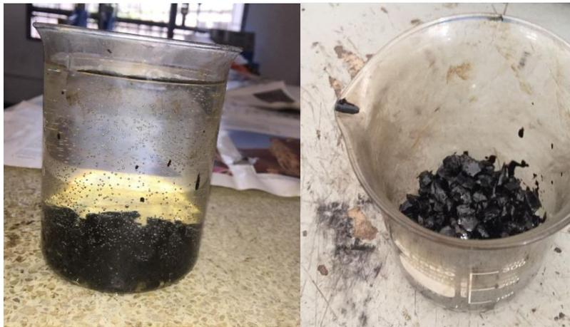
Ilustración 9 Ensayo Stripping del asfalto convencional
