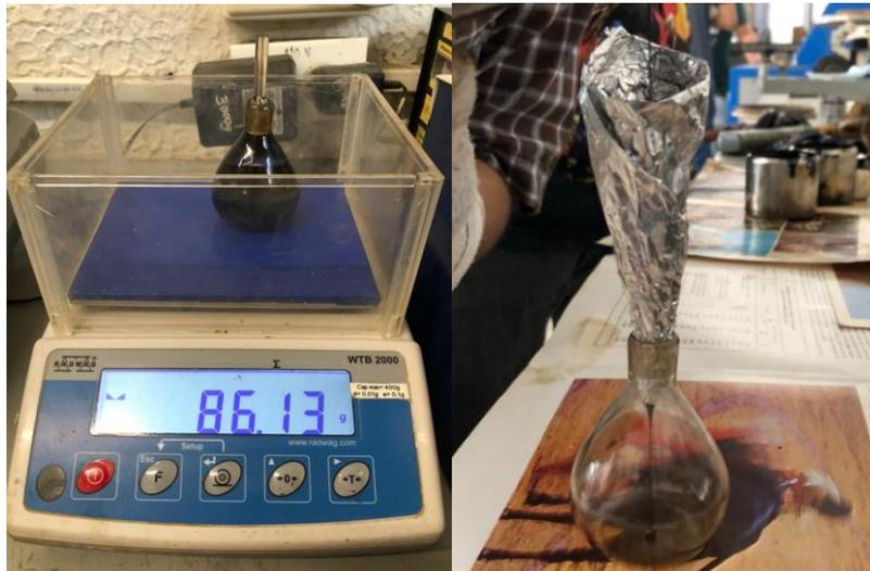
*Ilustración 4 Ensayos de gravedad específica asfalto convencional*
