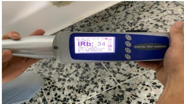
Para el procedimiento inicialmente se debe seleccionar la superficie a ensayar, en éste caso el ensayo solamente se realizará en columnas debido a la dificultad de practicarlo en las vigas.
