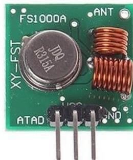
Figura 16. Módulo transmisor de frecuencia referencia (FS1000A). Fuente: [31]
