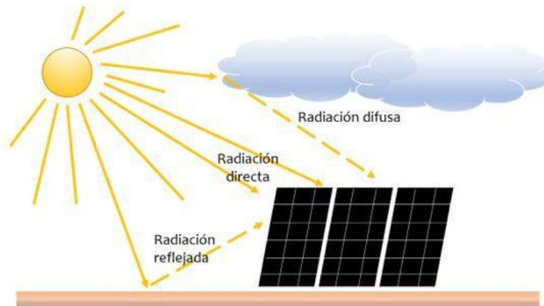
Figura 3. Tipos de radiación. Fuente: [13]
