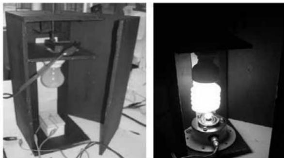
Figura 12. Montaje realizado para la elaboración de curvas I-V del fotodiodo. Fuente: [29].
