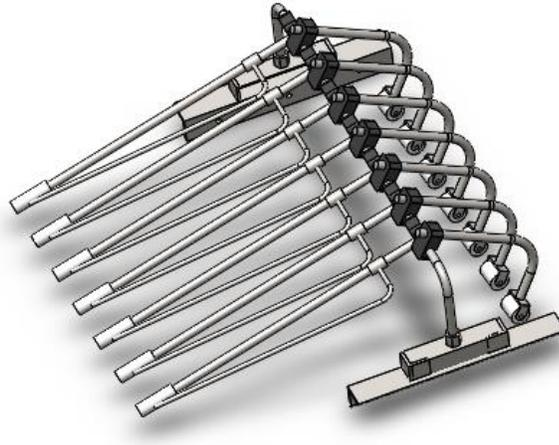
Figura A-75: Vista explosionada de sistema de doblado
