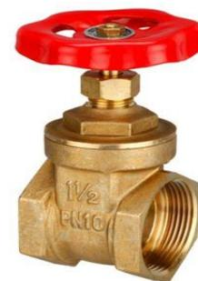
**1. Válvulas tipo Cortina:** La válvula tipo cortina se caracteriza principalmente por levantar una cuchilla o compuerta que permite el libre paso de fluidos son de operación más larga que las de válvulas de mariposa ya que necesita una vuelta enterar para dar posición de cerrado a posición abierta.
