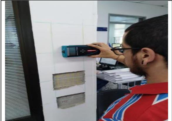
6. Ensayo con el Ferro-escáner.
