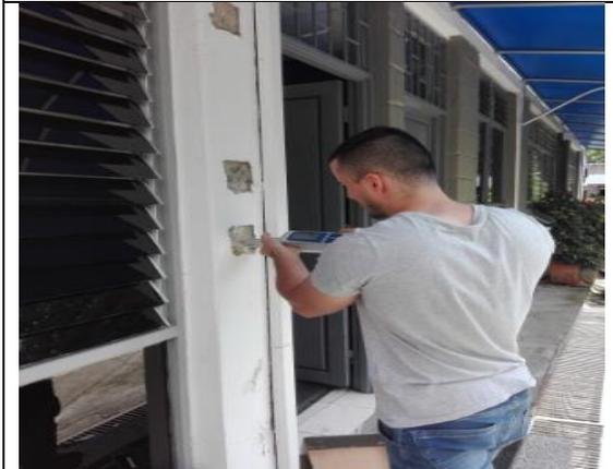
8. Ensayo de Esclerometría.
